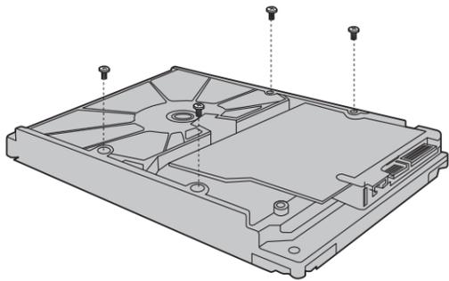
2. 打开机箱上盖，再将硬盘上的螺丝对准机箱底部预留孔。
