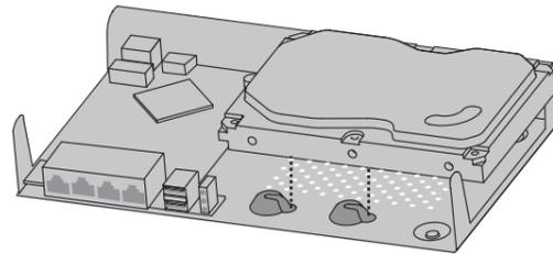
3. 推动硬盘，将硬盘插入对应的硬盘插座中，再拧紧硬盘固定螺丝。
